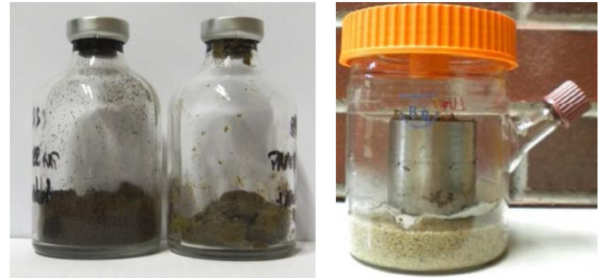
Abb. 15: Serumflaschen und Glaszylinder zur Messung der potentiellen Methanbildungs- und oxidation.
