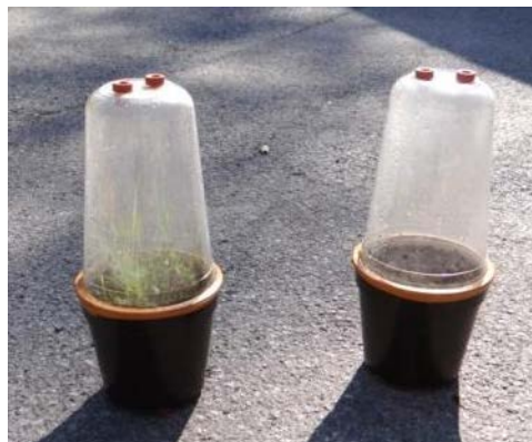
Abb. 10: Messtöpfe mit gasdichten Kunststoffhauben.
