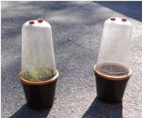
Abb. 10: Messtöpfe mit gasdichten Kunststoffhauben.
