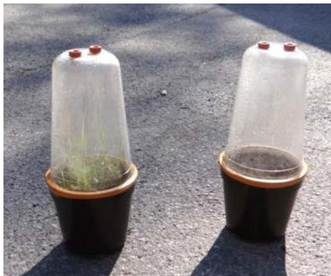
Abb. 8: Messtöpfe mit gasdichten Kunststoffhauben.
